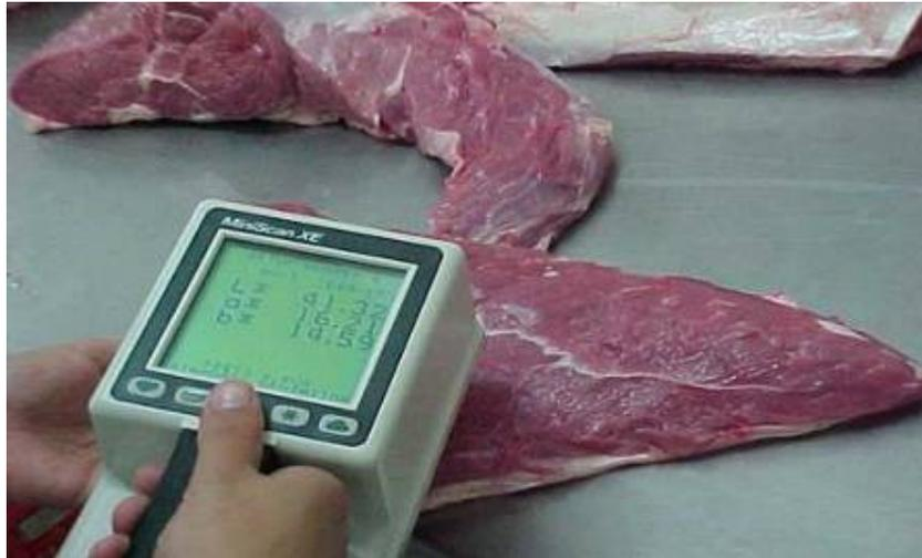
**Figura 4:** Aparelho utilizado para medição da cor em carnes.
