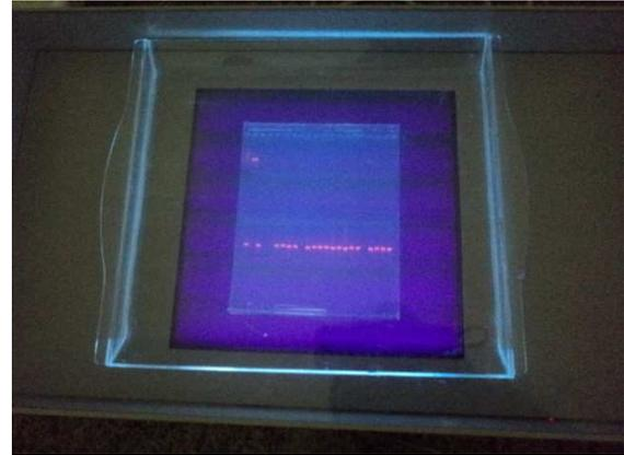
FIGURA 30: Transluminador utilizado para visualização do gel com as reações logo após a saída da eletroforese.
