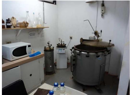
FIGURA 6: Sala de esterilização de materiais onde se encontram três autoclaves.
