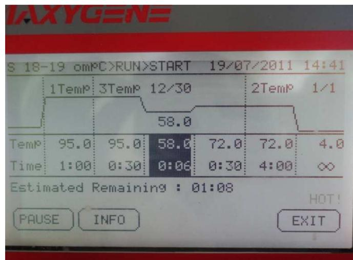
FIGURA 27: Visor do Termociclador, contendo as etapas do PCR com o número de ciclos e a temperatura de cada uma delas.
