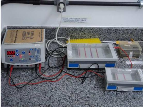
FIGURA 28: Aparelho de eletroforese e a cuba para suporte do gel de agarose.
