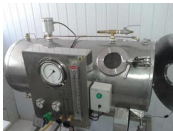
**Figura 2.** Fotografia da câmara hiperbárica tipo monoplace. **Fonte:** O Autor (2018).
