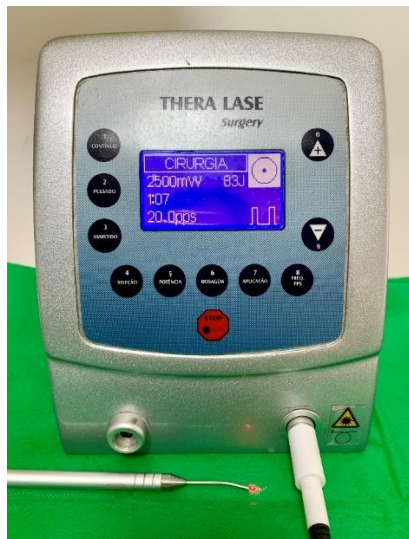
Figura 1. Laser Thera Lase Surgery utilizado na correção de distiquíase. Com configurações de potência a 2500mW, 20.0pps e energia de 83J, sendo que esta última foi correspondente à energia convertida no tecido alvo.
