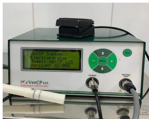
Figura 3. Gerador de pulsos para eletroquimioterapia VetCP125 com eletrodo agulha acoplado
